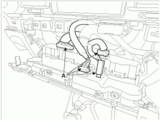
6. 拧下固定螺钉，从中央仪表板(B)上拆卸暖风和空调控制器(A)。
