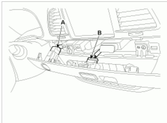
4. 拧下螺钉，拆卸暖风和空调控制器 (A)。
